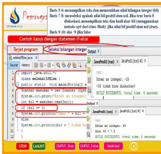
Gambar 2. Contoh screen program dengan animasi pointer; output-program, dan deskripsi
